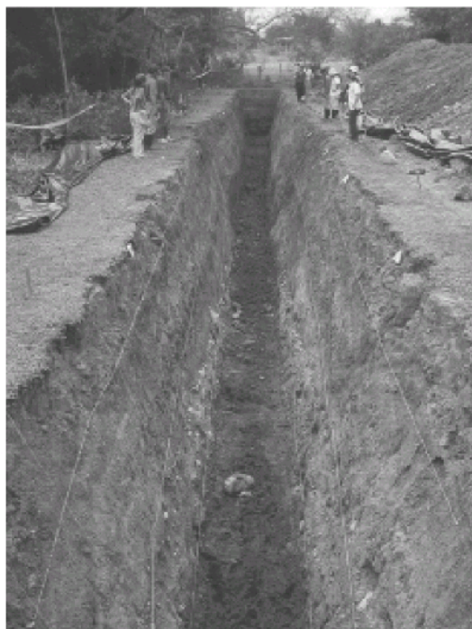
Figura 40. Reticulado final de las paredes de la trinchera. En color amarillo, los hilos horizontales; en color verde, los hilos verticales.
