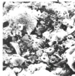
\text{CaCO}_3 foraminifera infilling, 1380x, SEM
